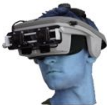
図 1-9：透過型 HMD の例 9
