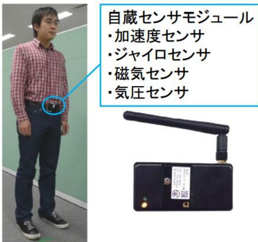
図 10 腰部に固定された PDR 装置<sup>[25]</sup>
