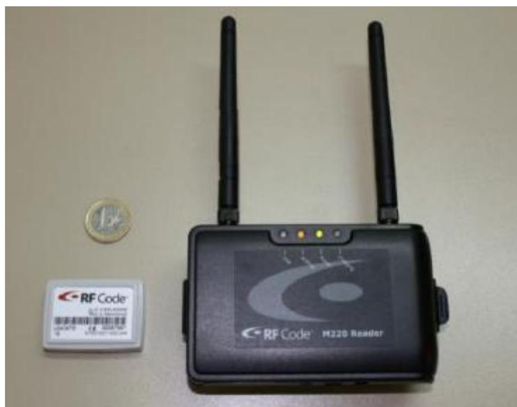
図 13 RFID Tag<sup>[35]</sup>
