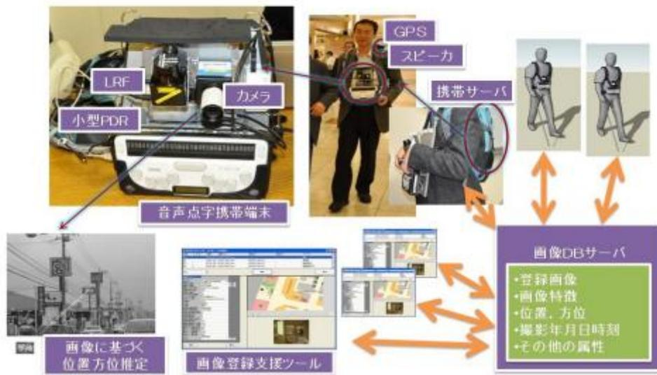
図 23 視覚障害者向けの測位システム(PDR 装置, LRF などを使用) [54]
