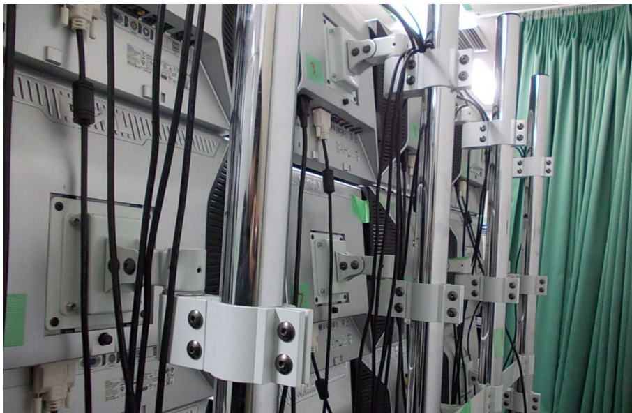
図15：本研究で用いたタイルドディスプレイ（裏面）
