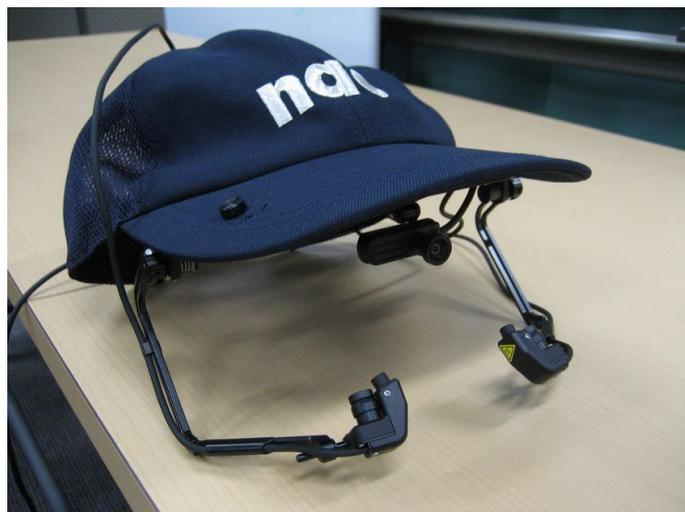
Fig. 3.16 視線計測装置 EMR-9
