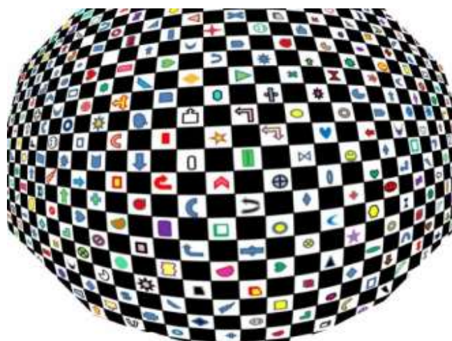
図 3-17 : 歪み補正をチェックボードに適用した様子
