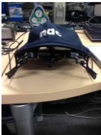
図 8-2 : 視線計測機 (EMR9)
