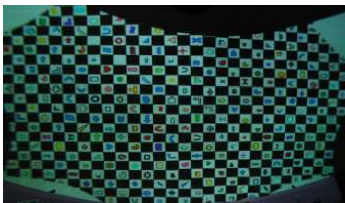
図 3-18 : 歪み補正をしたチェックボードをドームに投影した様子
