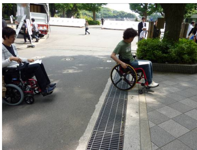
図 3-11 車いすに乗って排水溝の上を通過する様子
