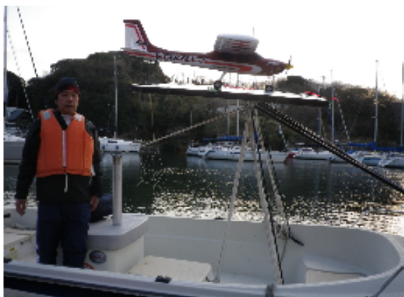
図 4.12 高速船に固定したプラットフォーム 図 4.13 滑走板迎え角調整ロープを安全ネット
