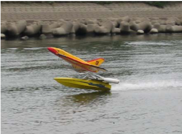
図 1.4 小型ラジコンボートと機体を用いた高速船からの離陸テスト
