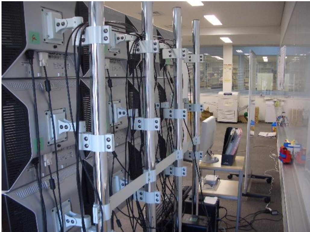
図 15: 構築したタイルドディスプレイ(裏)
