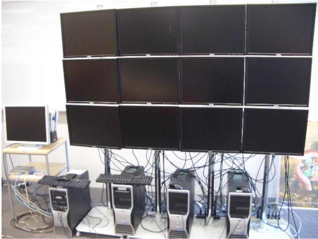
図 14: 構築したタイルドディスプレイ(表)
