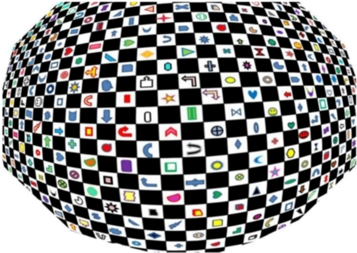
図 2.17. 歪み補正をチェッカーボードパターンに適用した画像
