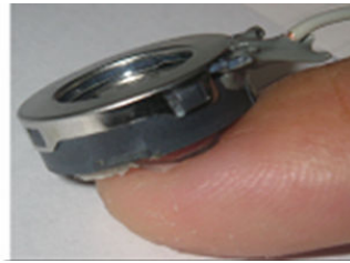
図 1.19 爪装着型ディスプレイ[安藤 04]
