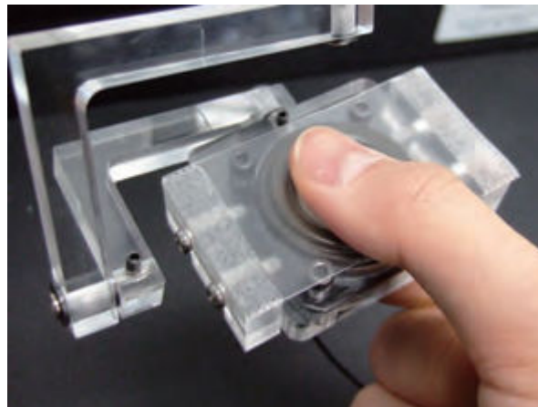
図 5.14 ボイスコイルを用いた皮膚感覚ディスプレイ
