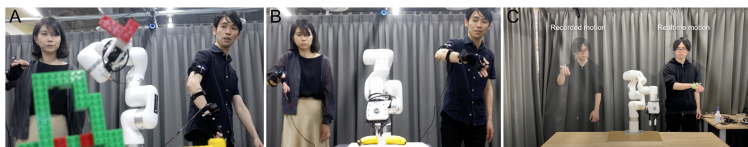
図 3.1 融合アバターのイメージ。(A)、(B) 2人でリアルタイムに1つのロボットアバターの融合して作業を行なう。(C) あらかじめ記録されたデータと融合して作業を行なう。
