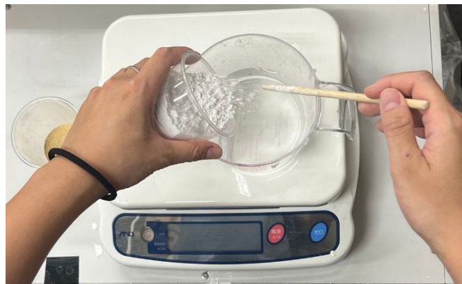
図 3.22 石膏を型に分散して注ぐ様子
