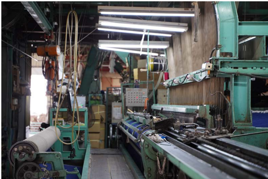
図 5.1 堀田カーペット工場のウィルトン織機
