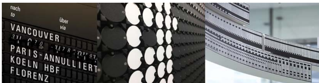
パタパタとパネルやドットが回転する機構のディスプレイ
