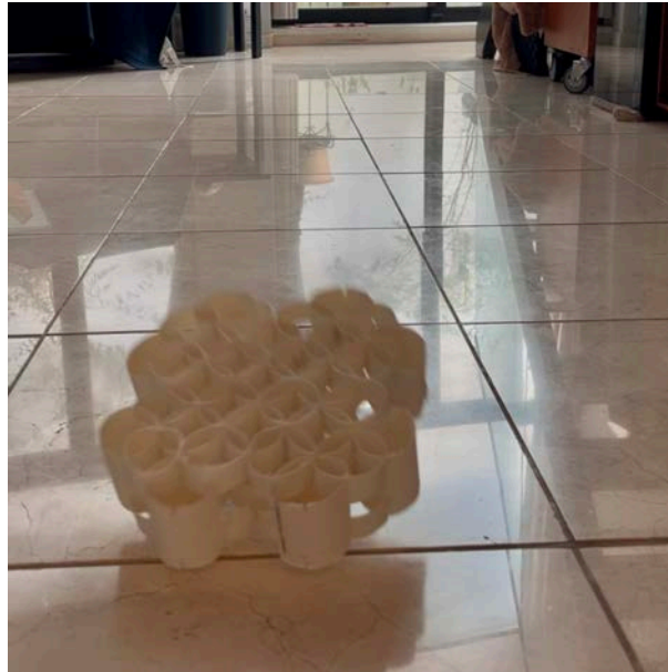
図 4.13 落下テスト（パターン 3/50cm） - 断面から落下した瞬間
