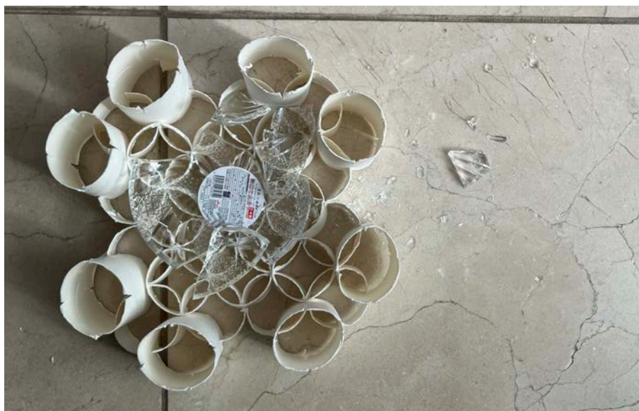
図 4.20 パターン3（曲面から落下） - 落下後の中身の様子
