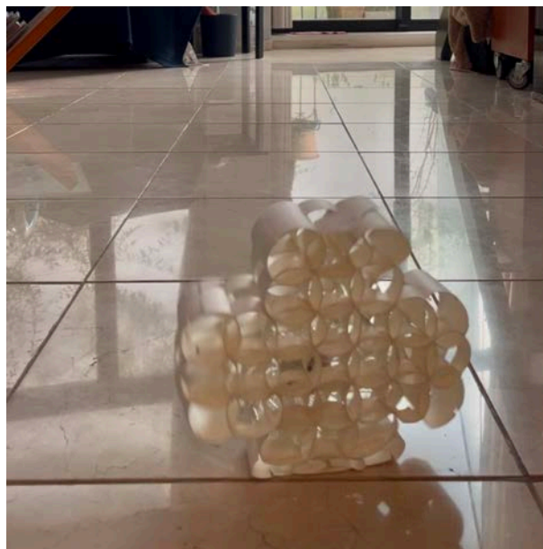
図 4.14 落下テスト（パターン 3/50cm） - 曲面から落下した瞬間
