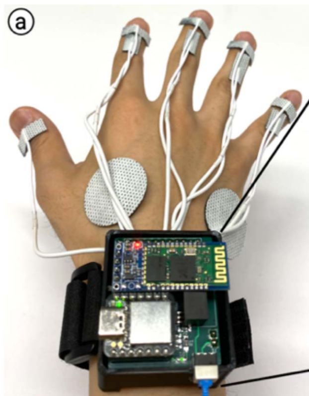
図 2.13: 電気刺激による触覚提示デバイス (Pedro ら [9] より抜粋)
