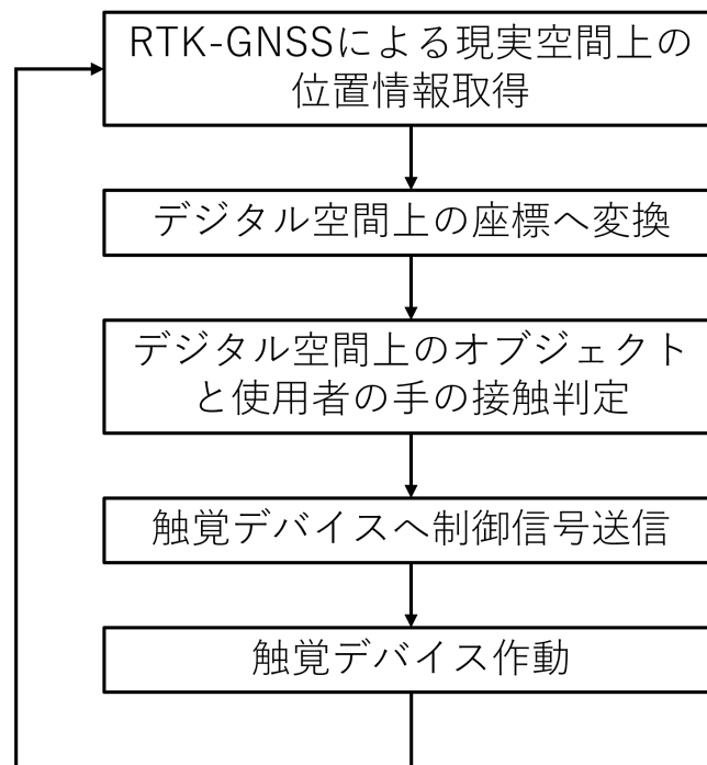
図 3.2: 触覚インタラクションシステムの処理フロー
