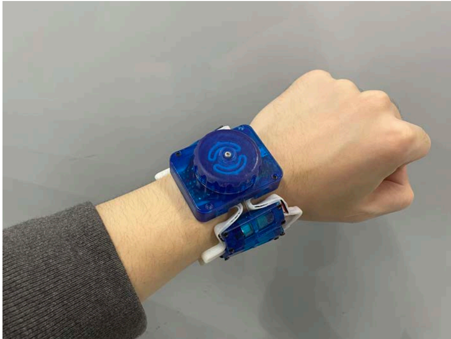
図 3.3: 手首装着触覚デバイスの外観
