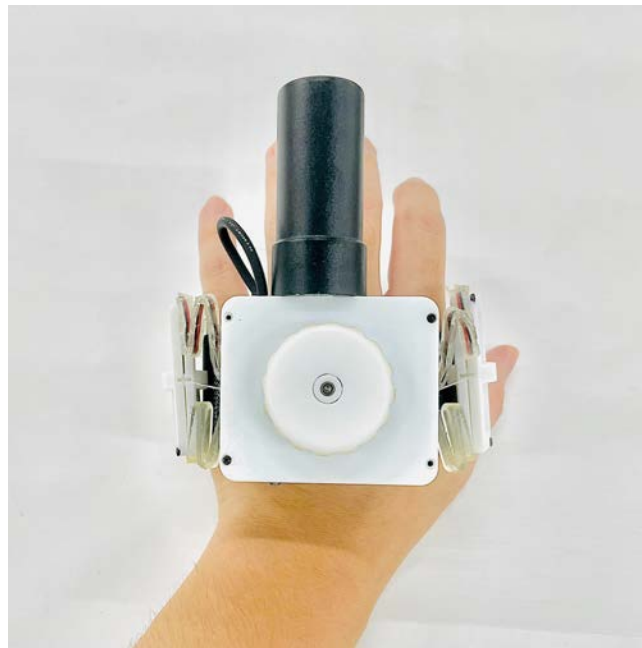
図 3.12: RTK-GNSS モジュールを搭載した掌装着型触覚デバイス
