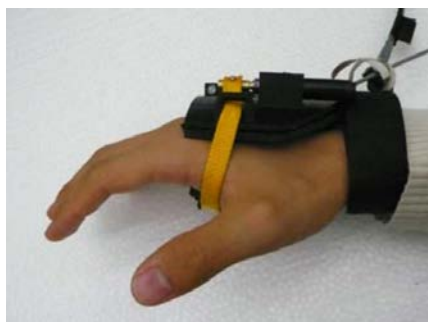
図 2.11: 掌装着型触覚提示デバイス (Minamizawa ら [7] より抜粋)
