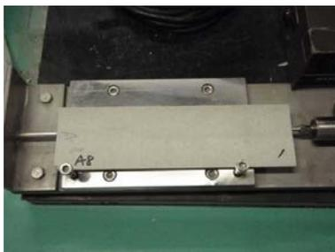
図 4.11 寸法変化率の測定の様子
