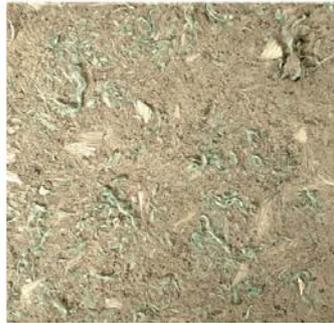
漁業に関わる廃棄物。廃プラスチック類に分類される。回収されずに海に漂う漁網は、海の生物に絡まるため課題視されている。本サンプルで用いたのは、曲げ強度を補強するビニロン繊維が配合された廃棄漁網である。
