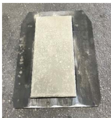
図 4.6 脱版工程後の様子
