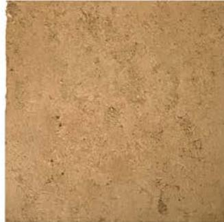
農業に関わる廃棄物。国内で年間約 200 万トン、世界中では年間約 1 億トン以上排出される。2014 年時点では籾殻の約 2 割が廃棄され、約 3 分の 1 が有効利用されていないと推計されている。もみ殻を焼却した灰を使用すると、曲げ試験と圧縮試験にて、わずかに強度が増すことがわかっている。
