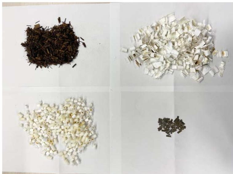
図 3.6 タバコ素材の分解後
