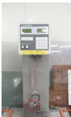
図 4.10 試験片の位置（赤丸部分）
