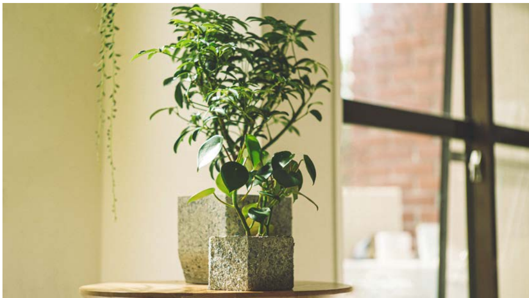
図 3.28 ジーンズくずを用いたコンクリート製の植木鉢
