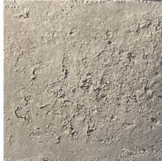
漁業に関わる廃棄物。養殖場や漁港、レストランでの廃棄が多く、推定発生量は約16万トン。養殖過程の牡蠣殻は廃棄物処理法に基づき処分することが求められており、各産地では廃棄方法が課題となっている。コンクリートに加えることで、ひび割れの基点となりやすい空隙が小さくなる。
