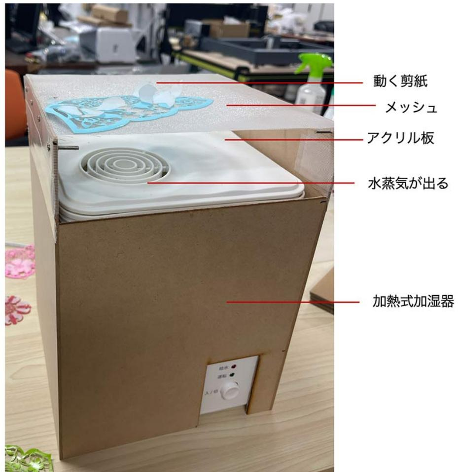
図 3.6 「動く剪纸」の装置
