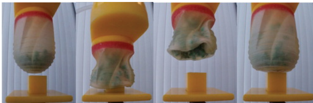
図 2.26 マルチマテリアル 3D プリンターを用いたソフトグリッパー（ [19] から抜粋）
