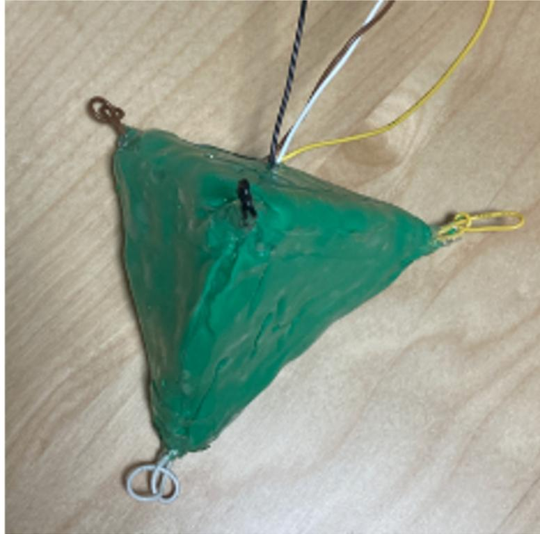
図 4.1 小麦粘土を用いた音楽インタフェースのプロトタイプ
