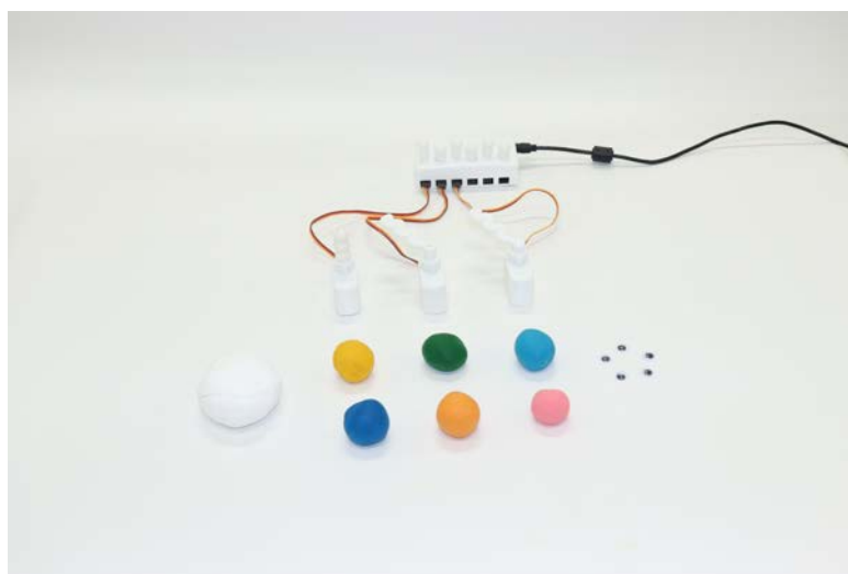
図 3.4 サーボモータを用いたプロトタイプ
