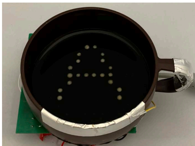
図 2.4 泡ディスプレイによる表示の例：「A」 [5] より引用
