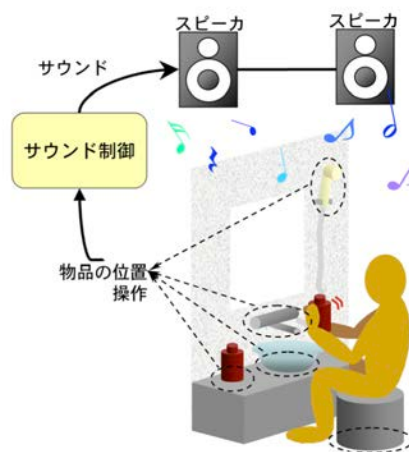
図 2.9 浴槽を利用したシステム [8] より引用
