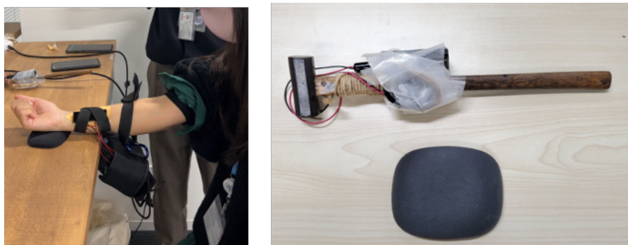
図 4.6 やけど感提示デバイス (左, ) 触覚提示ハンマーと Lipo バッテリー風クッション (右)
