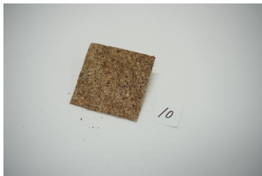
図 3.25 試作品 10/表/含有率 30%/和紙/ 図 3.26 試作品 10/裏/含有率 30%/和紙/ グリセリン 5%/寒天 5%
