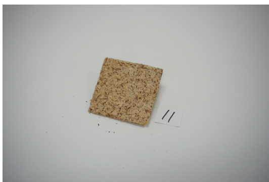
図 3.27 試作品 11/表/含有率 30%/和紙/ 図 3.28 試作品 11/裏/含有率 30%/和紙/ グリセリン 10%/寒天 5%
