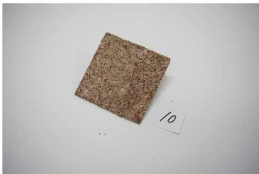
図 3.25 試作品 10/表/含有率 30%/和紙/ 図 3.26 試作品 10/裏/含有率 30%/和紙/ グリセリン 5%/寒天 5%
