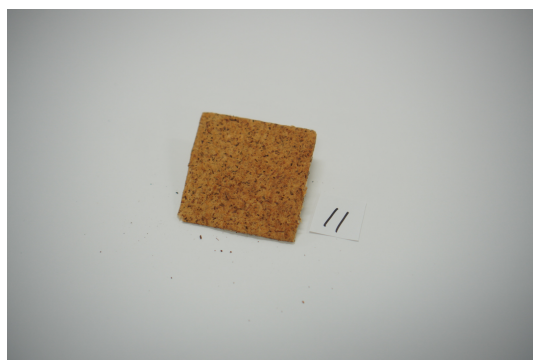
図 3.27 試作品 11/表/含有率 30%/和紙/ 図 3.28 試作品 11/裏/含有率 30%/和紙/ グリセリン 10%/寒天 5%
