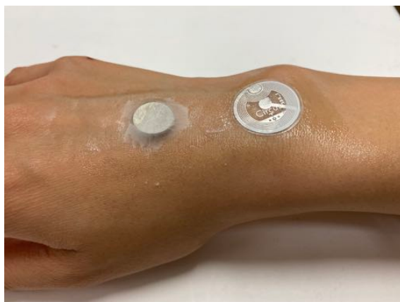
図 5.6 手首から手の甲にかけて貼り付けたネオジム磁石と RFID タグ
