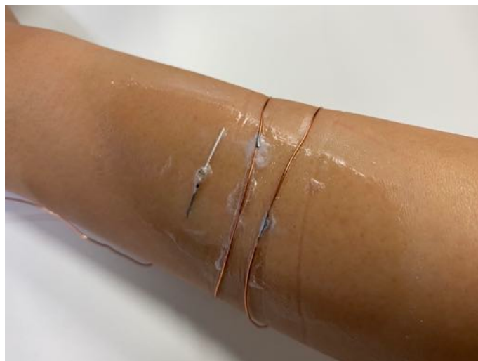
図 4.14 皮膚上に実装した LED 点灯回路：オフ状態
