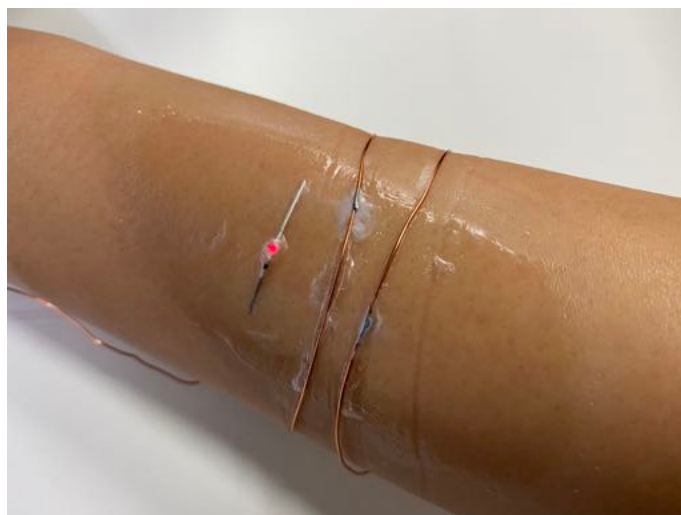
図 4.15 皮膚上に実装した LED 点灯回路：オン状態
