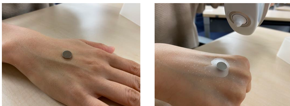
図 4.22 永久磁石を使用した磁性をもった人工皮膚
