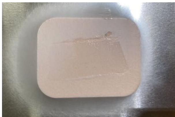
図 4.4 導電性をもった人工皮膚（塩化ナトリウム水溶液添加浸透液）
