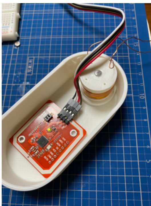
図 5.3 RFID リーダと電磁石が組み込まれた筐体
