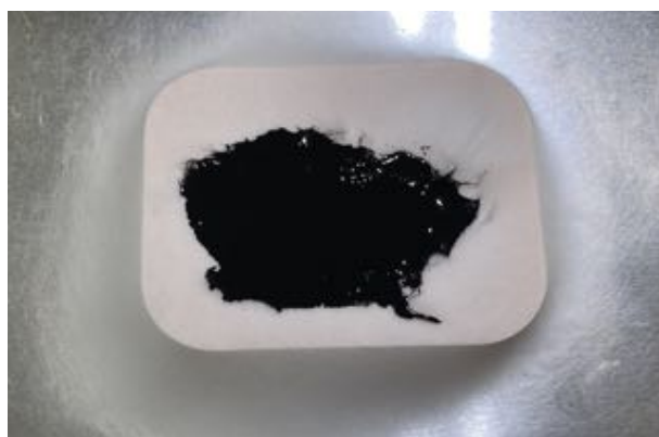
図 4.5 導電性をもった人工皮膚（導電性インク）
