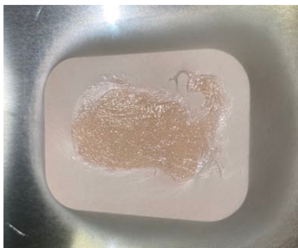
図 4.9 ワセリンを使用して実装された絶縁性を持った人工皮膚
