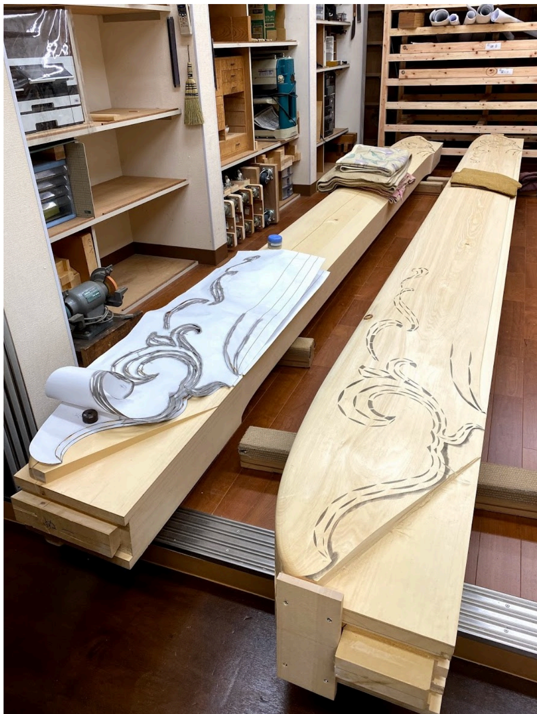
図 2.5 制作中の寺社彫刻に使用する梁（筆者撮影）
