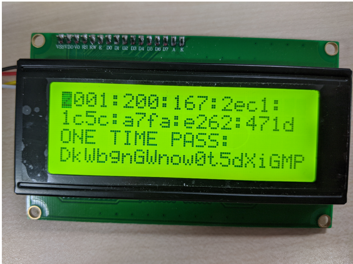
図 5.2 IoT ノードにおける LCD の表示結果 1
