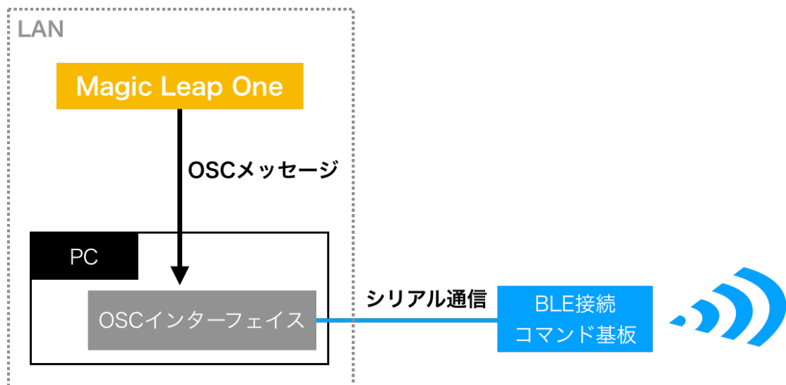
図 4.17 OSC インターフェイスを用いた際の制御構成
