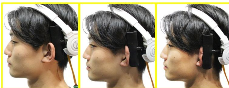
図 4.13 Altered Pinna System による耳介の開閉
