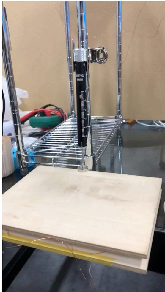
図 3.20 実験セットアップと無出力時のテンションゲージの指示位置
