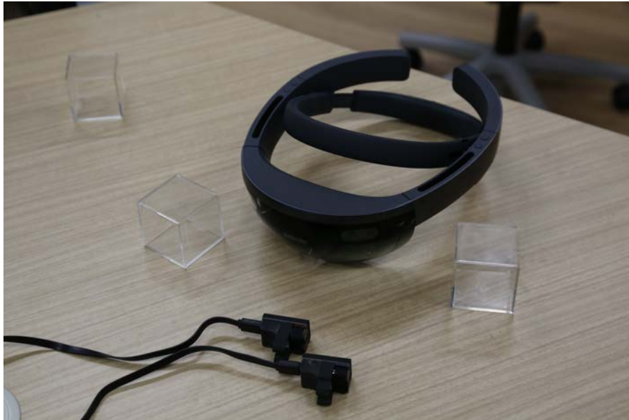
図 4.2: Augmented Haptics のための, HoloLens [27], ウェアラブル触覚提示デバイス, アクリルボックス
