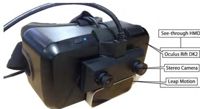
図 4.1 see-through HMD の仕組み
