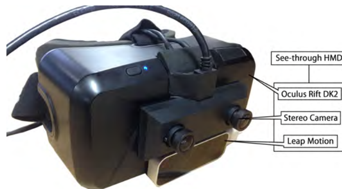
図 4.1 see-through HMD の仕組み
