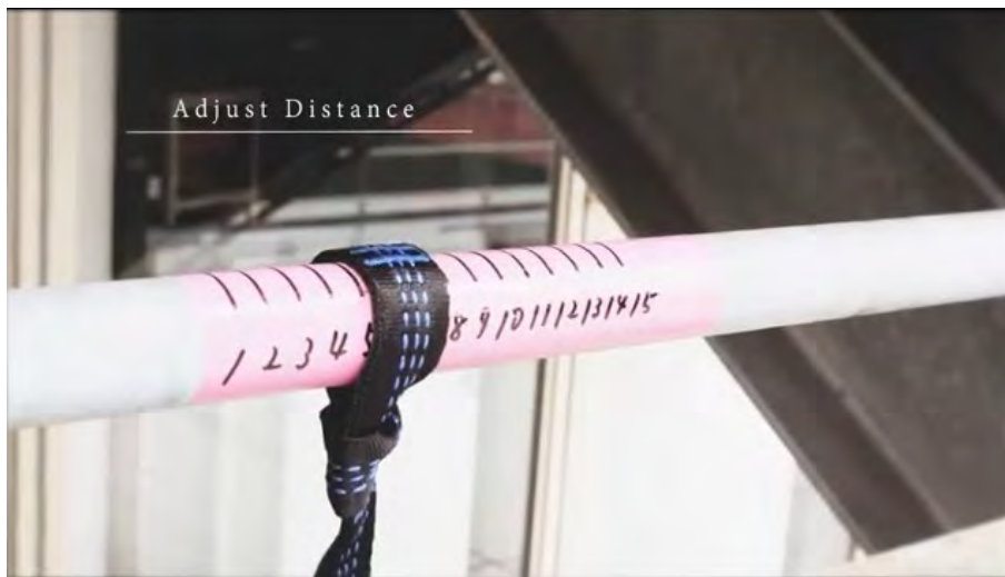
図 4.13: 定位置を調整出来る仕組み
