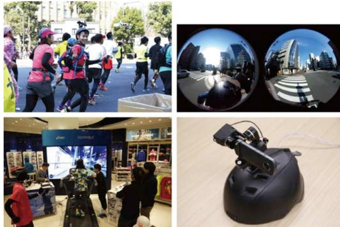
図 2.10: マラソンランナーの視点をリアルタイムに遠隔地のユーザーに共有するシステム [?]
