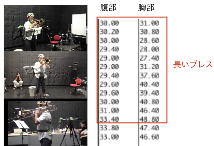
図 3.24: プロトロンボーン奏者の吸気時の胸部と腹部のセンサーの値
