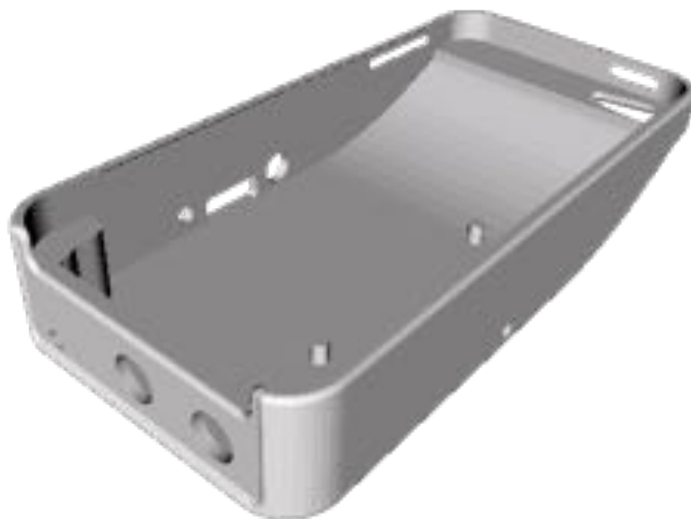
図 4.19: HapticAid パワーアンプケースの 3D モデル
