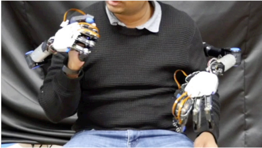
図 4.40: 拡張腕の開閉によるユーザー拳へのセルフタッチ
