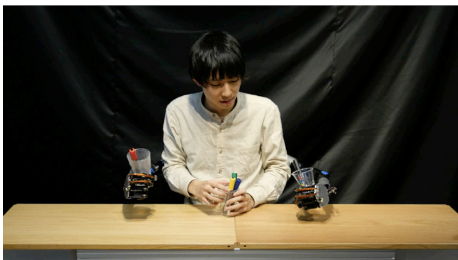
図 4.38: 左右両側拡張腕でのカップ把持とペン挿入後
