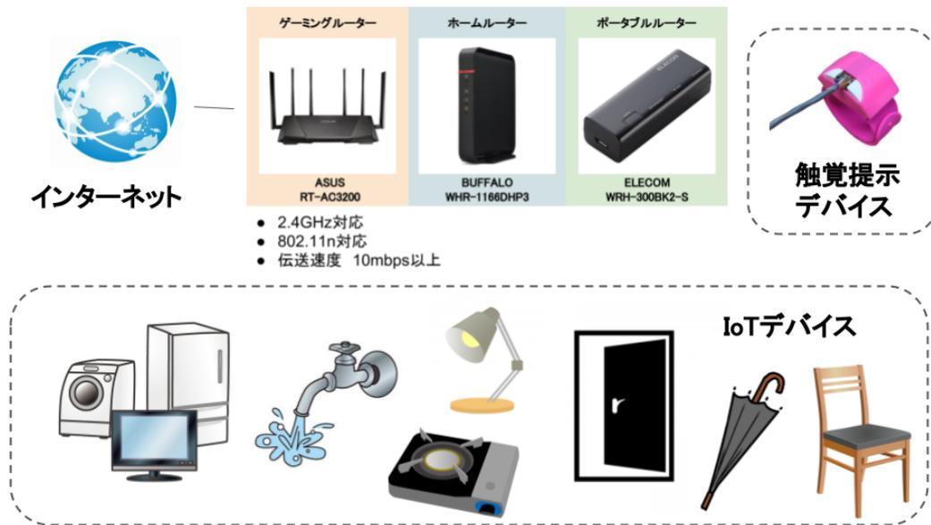
図 3.8: IoT 機器とネットワーク構成
