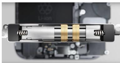
図 2.17: Taptic Engine<sup>12</sup>
