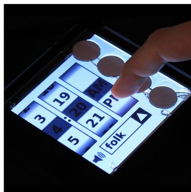
図 2.10: piezo アクチュエータを配置した Tpad<sup>9</sup>
