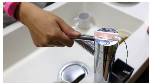
図 4.8: 金属部分へのタッチセンサの装着
