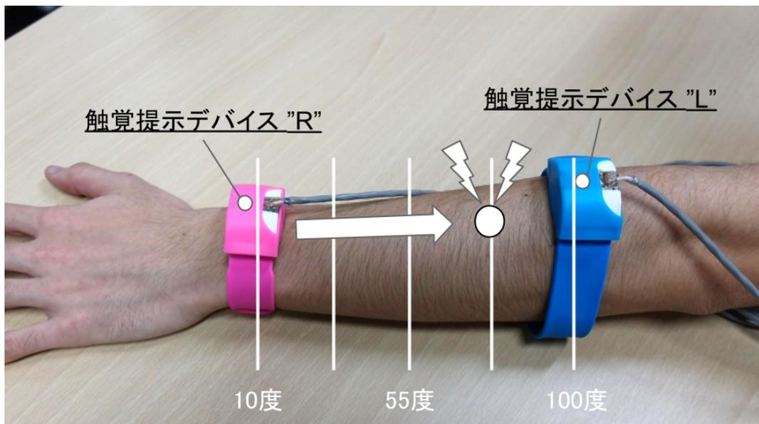
図 4.22: 温度上昇による振動触覚の移動
