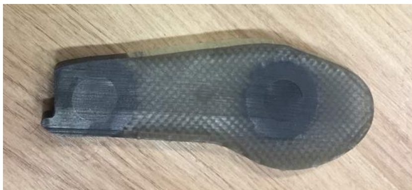
図 4.10: 3D プリントによるインソールプロトタイプ 3
