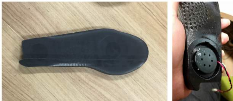
図 4.9: 3D プリントによるインソールプロトタイプ 2
