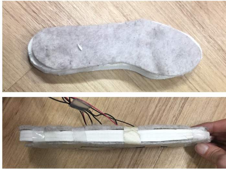
図 4.8: スチレンボードによるインソールプロトタイプ 1
