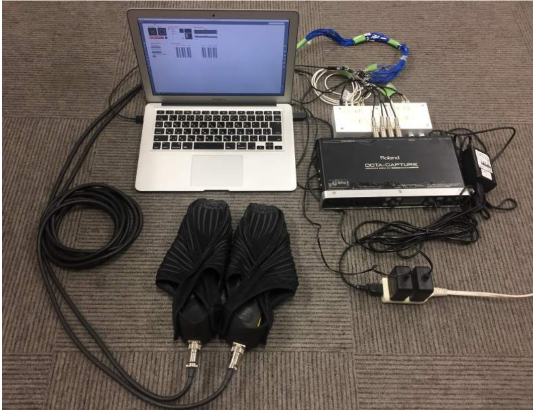
図 4.21: 1st プロトタイプの使用機材一式
