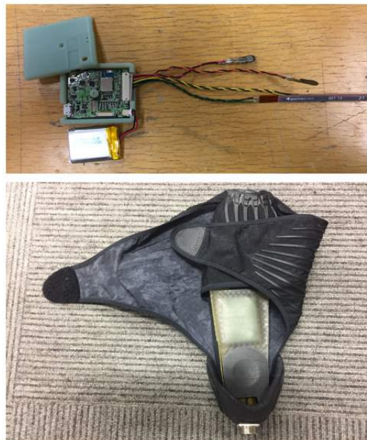
図 4.25: ソール中央部へのモジュール埋め込み
