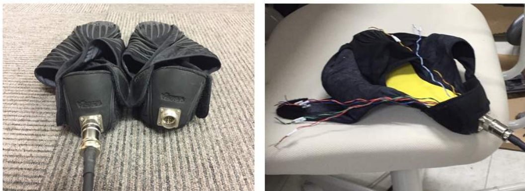
図 4.7: 12 芯ケーブルの取り付け
