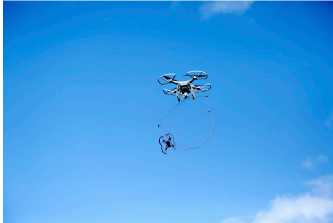
図 5.12: ドローンがドローンを捕まえている様子
