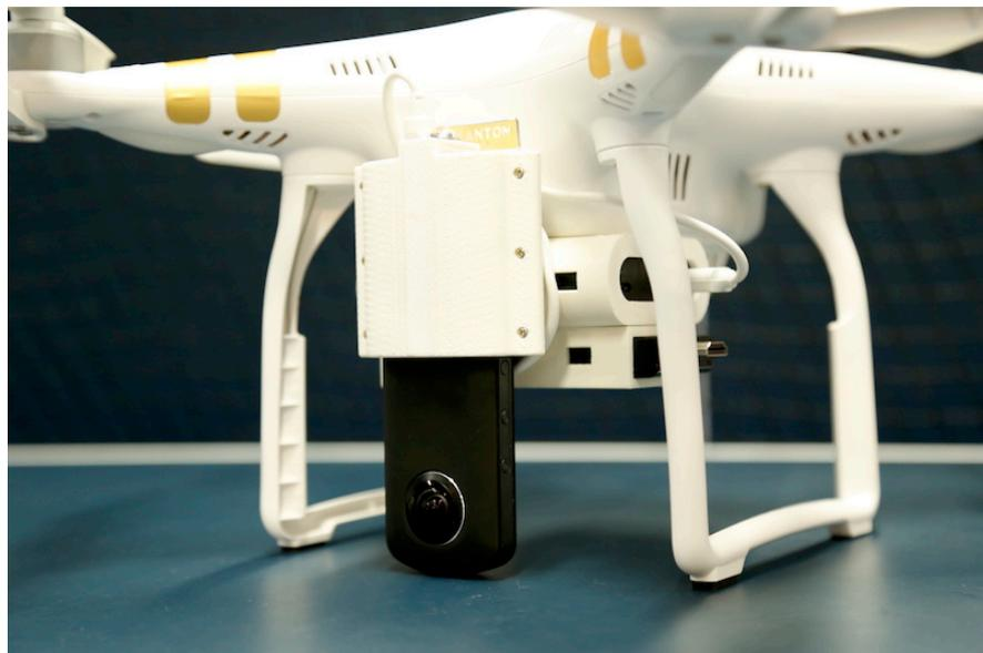
図 4.11: 第 2 プロトタイプにおける頭部機構
