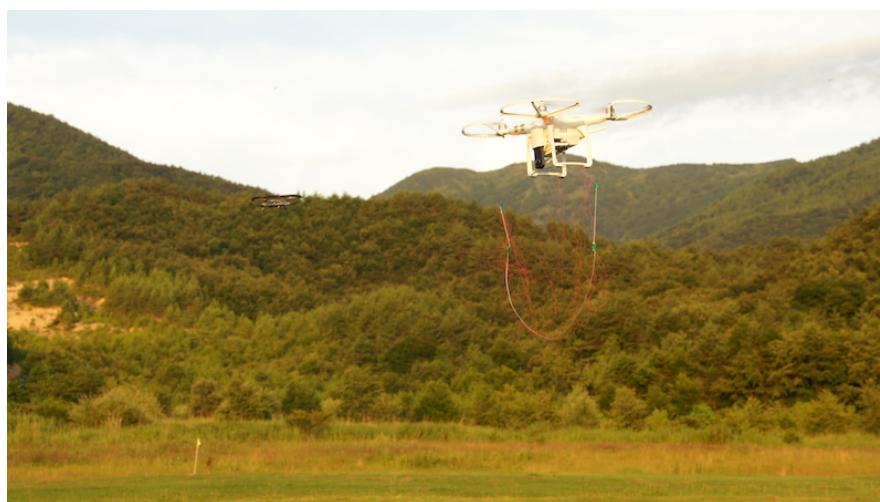
図 5.18: 飛行型トレイグジスタンスロボットでドローンの捕獲を試みている様子
