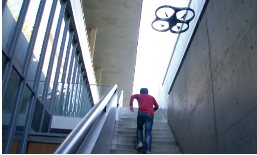
図 2.1: 空中自由視点でのコンテンツ撮影手法である「Flying Eye [7]」
