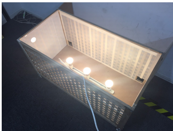
図 3.3: Hue をベンチの内部に取り付けている様子
