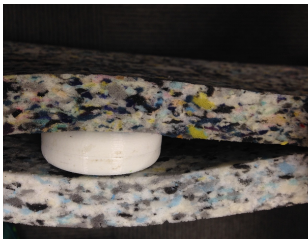
図 3.7: ウレタンマットの間に振動子を挟み込む
