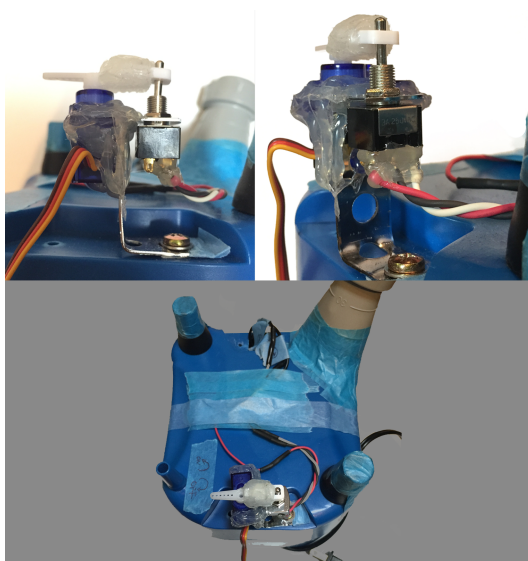
図 3.38: エアポンプのサーボモータのスイッチ機構
