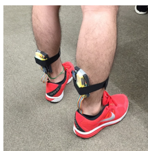
図 3.15: インソール型圧力センサーの装着したときの様子
