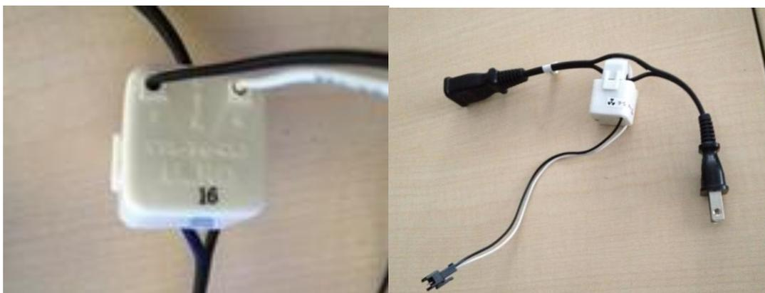
図 7.2 : 超小型クランプ式交流電流センサ CTL-10-CLS
