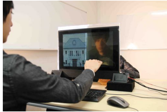
図 4.15: 右半分を透明にし、ディスプレイを通して face to face のコミュニケーションを行う様子
