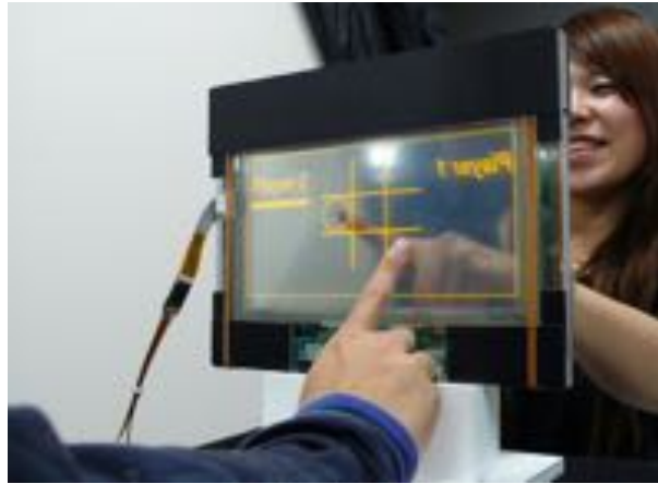
図 2.11: 岩瀬らが開発した透明インタラクティブディスプレイ [11]
