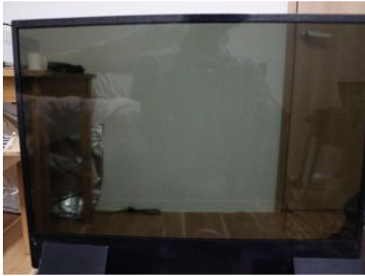
図 4.1: 本研究で用いた透過型液晶パネルに白を表示した様子
