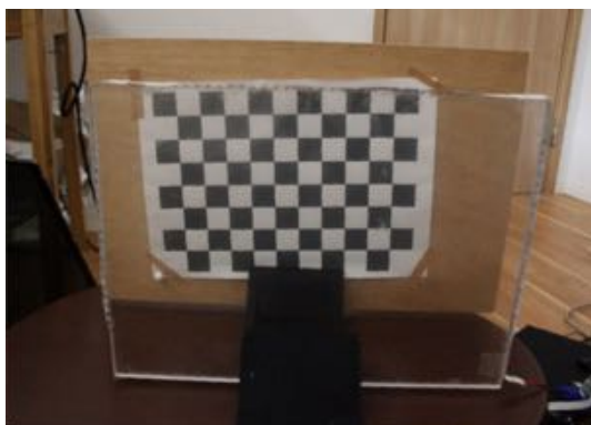
図 4.4: Endlighten に縁から光を当てた様子 LED が OFF の状態
