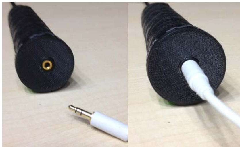
図 3.10 ラケット型デバイスのグリップの底
