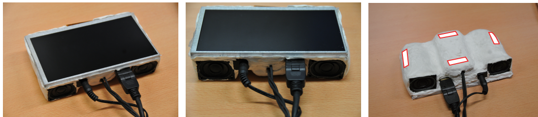
(1) 全体像 (2) 下部にスピーカー (3) 振動子を十字に設置
