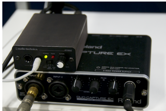
図 4.2: Roland DUO-CAPTURE EX と audio-technica マイクアンプ AT-MA2
