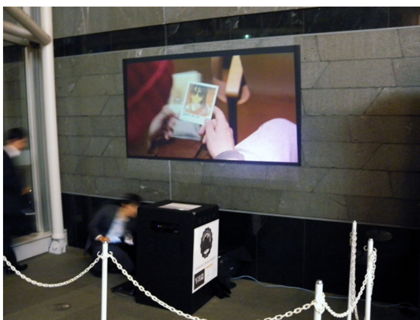
図 4.21: 超短焦点プロジェクタにより壁面 20cm の距離から投射する Nomadic Cinema
