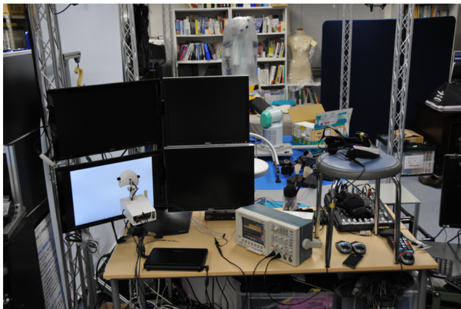
図 4.47: TELUBee におけるロボット-HMD 間の映像遅延計測の様子
