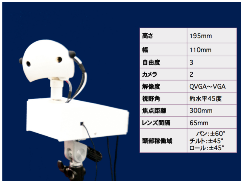
図 4.28: プロトタイプロボット Ver.3 の外観と概要
