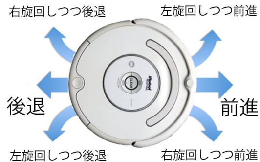
図 4.18: Ver.2 における移動台車の移動可能方向
