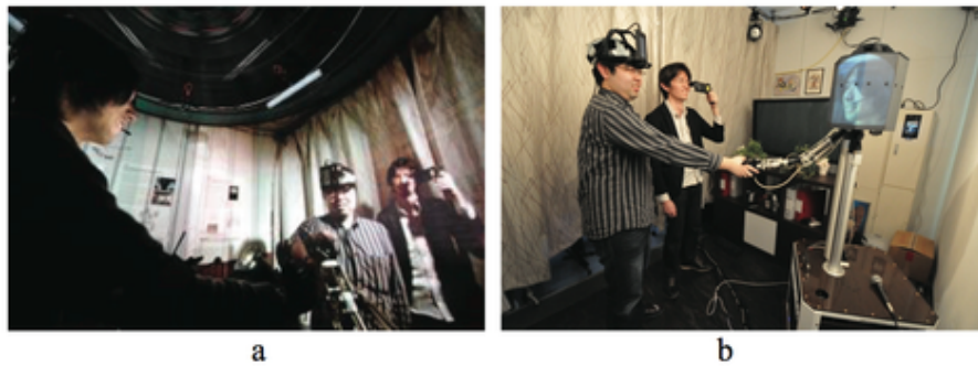
図 2.9: (a)Telesar4 [23] の操縦者 (b) 遠隔地のロボットが人とコミュニケーションする様子
