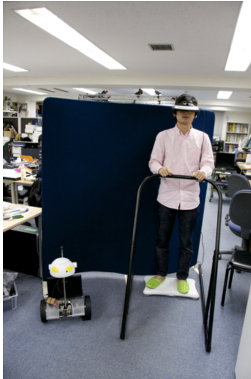
図 4.9: プロトタイプシステム Ver.1 の試作結果 (左: ロボット 右: コックピット)
