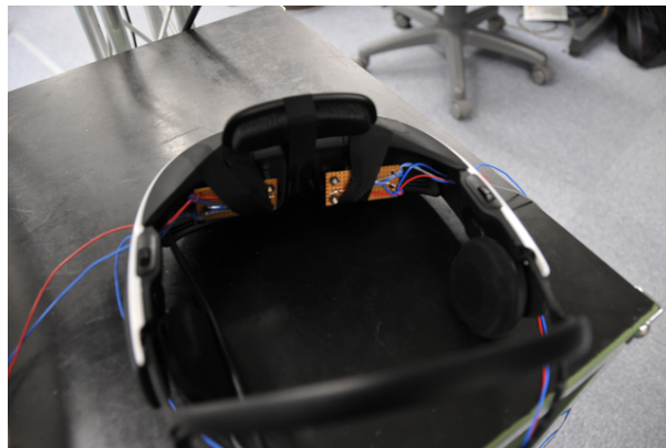
図 4.51: HMD の右目映像と左目映像計測のセットアップ
