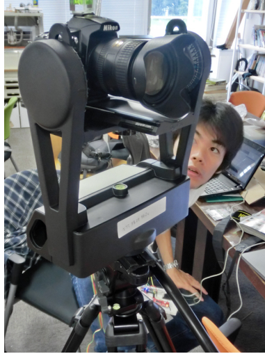
図 5.7 GigaPanPro を流用した連続撮影装置
