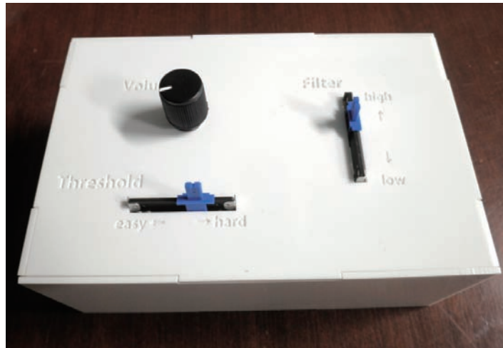
図 4.7: 操作盤の外観
